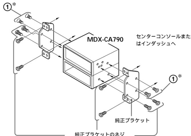
\* 付属の皿ネジ①またはトラスネジ②で取り付けてください。他のネジを使用すると故障の原因となります。また、車両側の純正ブラケットを通さず、本体に直接ネジを締め付けると故障の原因になります。
