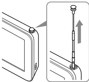
ホイップアンテナを伸ばしきらないと、ワンセグの受信感度が著しく悪くなったり、ホイップアンテナが固定されない場合があります。
