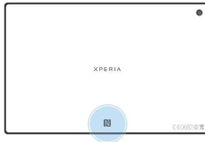
！ NFC 検出エリアの場所は機器により異なります。NFC を使用してデータを別の機器と共有する場合は、その機器の取扱説明書を参照して確認してください。
