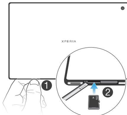
1. microSD カードスロットカバーとタブレットデバイスの底面のすき間に指先を入れて、microSD カードスロットカバーを外します。
