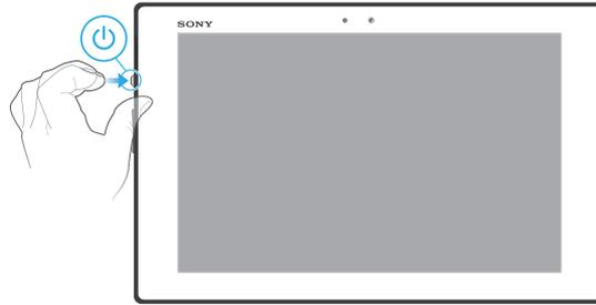
1. 通知ライトが一度点滅するまで、電源キー $\text{⏻}$ を長押しします。
