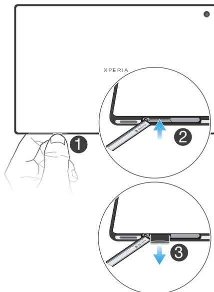
1. タブレットデバイスの電源を切るか、または**設定 > ストレージ > SD カードのマウント解除**で microSD カードのマウントを解除します。
